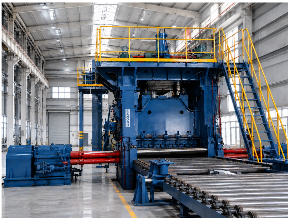
Baowu | EZW43CY-12x2200, para endireitamento de chapas de blindagem.
