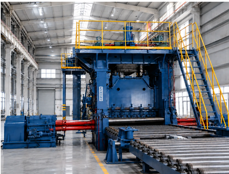
Baowu | EZW43CY-12×2200, para aplanado de placas de blindaje.
